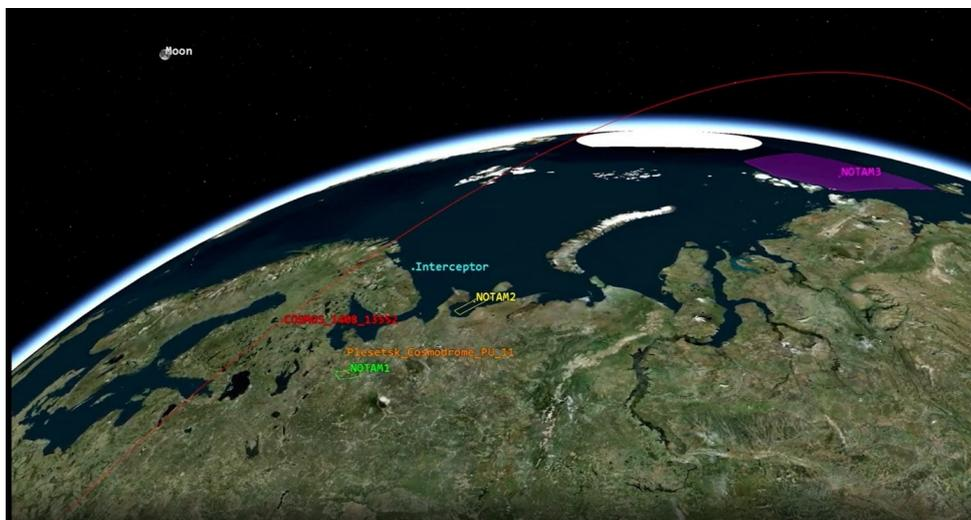
2<sup>ème</sup> étape : l'intercepteur a été tiré et après séparation des étages propulsifs principaux, le véhicule terminal est injecté sur une trajectoire proche de celle du satellite afin de se positionner au mieux, juste devant le satellite qui se rapproche (source : COMSPOC Corp.)
