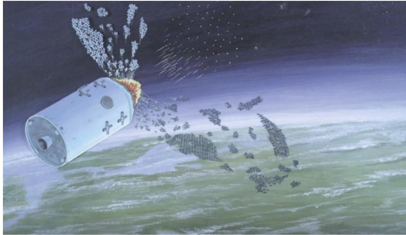
Le système co-orbital soviétique mettait une charge utile en orbite. Celle-ci se rapprochait alors progressivement de sa cible et projetait des fragments en passant à proximité, comme illustré dans la vue ci-dessus (**source** : DoD, *Soviet Military Power 1985*).
