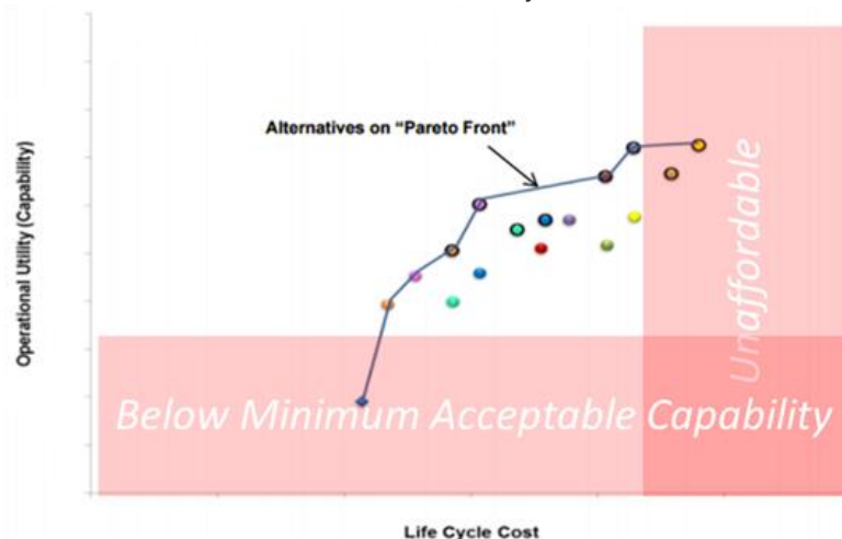
Figure 2 : Courbe illustrant l'ensemble des solutions techniques optimales (Pareto), selon la méthode d'analyse CCA
