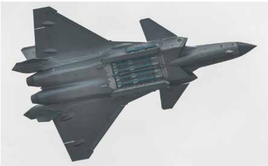
Un visuel sur la soute d'armement du chasseur Chengdu J-20 Source : emperornie – Wikimedia Commons
